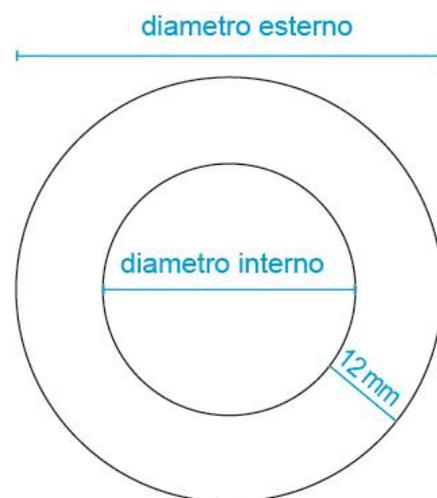
$$\text{diametro esterno} - \text{spessore} = \text{diametro interno}$$
